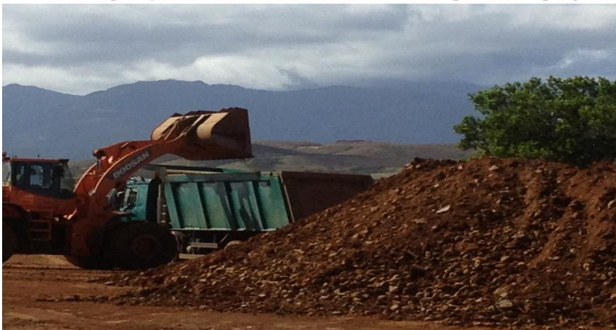
Le conducteur charge le camion de nickel. Le camionneur déversera à son tour le nickel dans les chalons avant d'arriver au minéralier.
