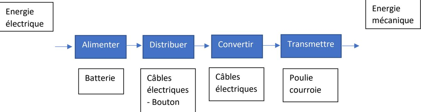
Exercice 2 : Tableau fonctionnel et chaîne d'énergie de la bouilloire électrique
