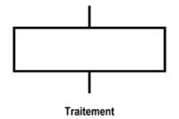
Ce symbole représente un action ou le traitement d'une opération à effectuer (généralement réalisé par un actionneur)
