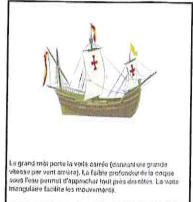
La grand mât porte la voile carrée (donnant une grande vitesse par vent arrière). La faible profondeur de la coque sous l'eau permet d'approcher tout près des côtes. La voile triangulaire facilite les mouvements.
