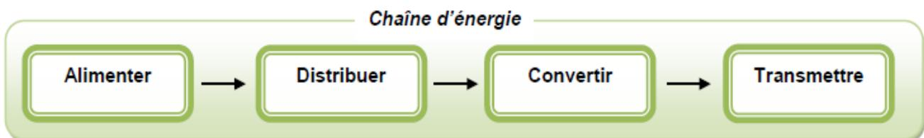
*Chaîne d'énergie de la maquette de plate-forme automatisée*
