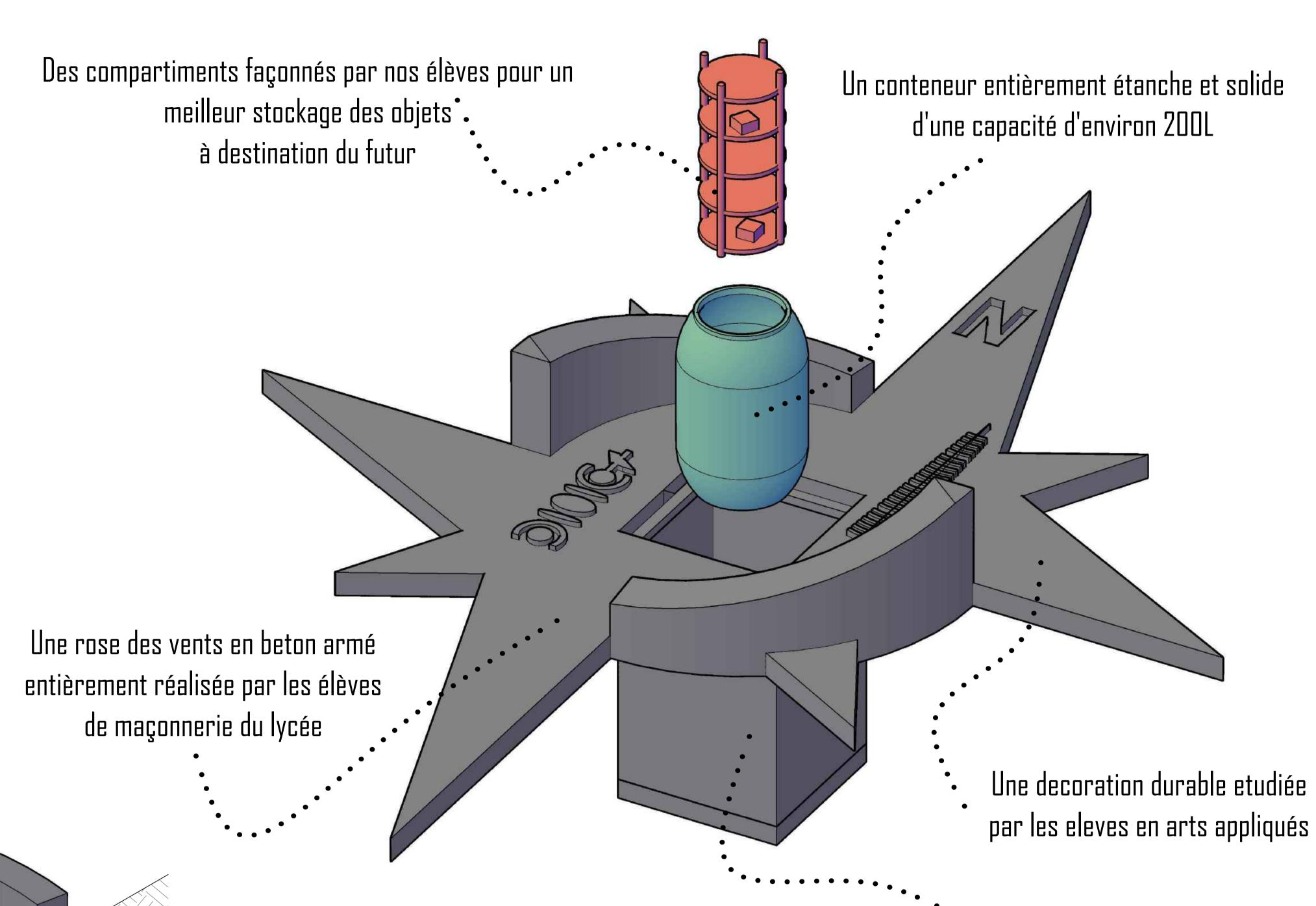
Partie enterrée en béton armé recevant la capsule temporelle environ à 1.30 mètres sous terre
