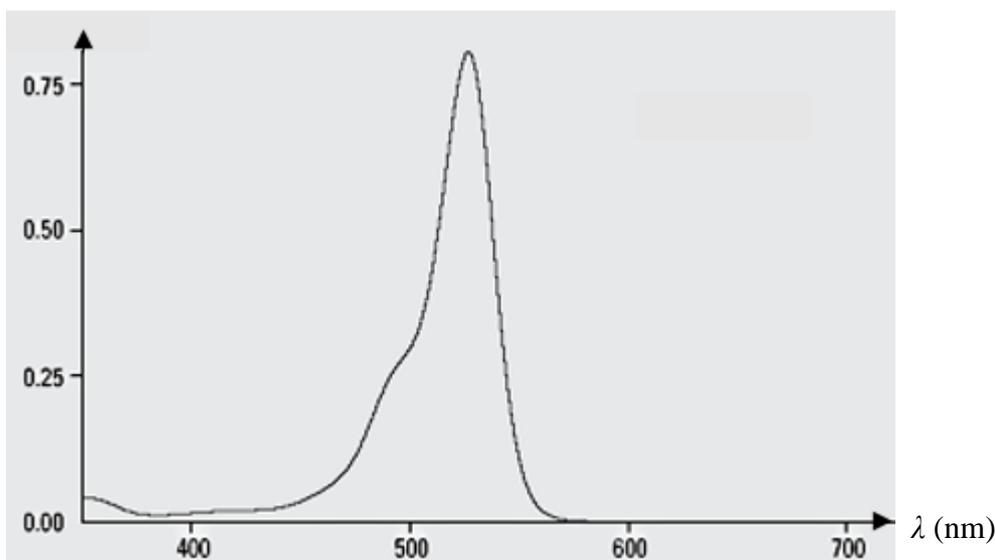
Figure 1 - Spectre d'absorption d'une solution aqueuse d'érythrosine
