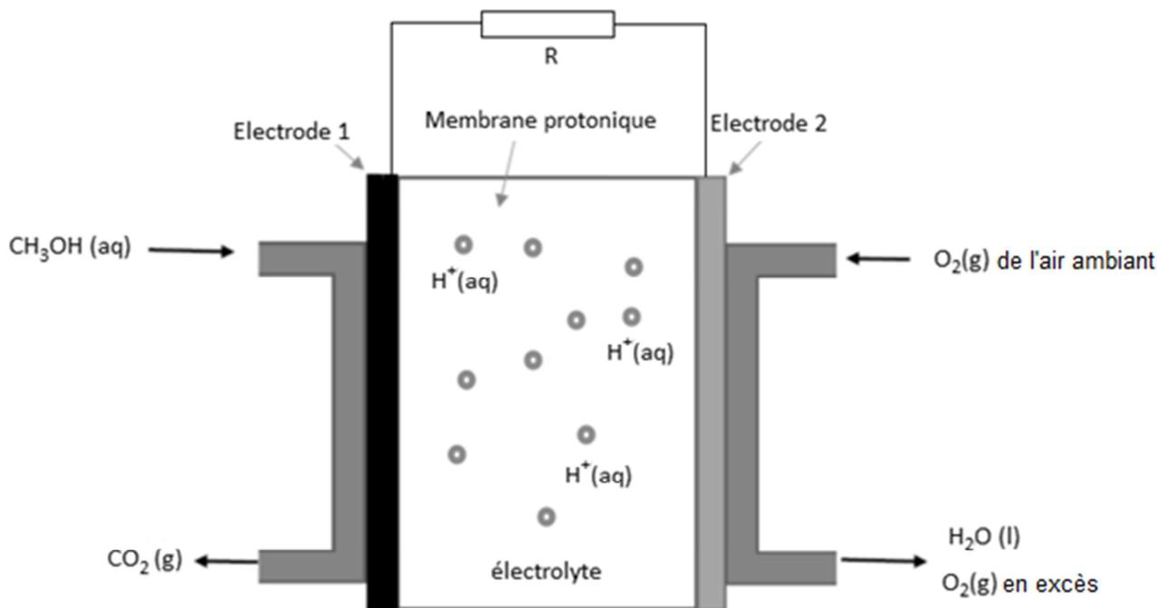
**Figure 1 : La pile au méthanol en fonctionnement**
