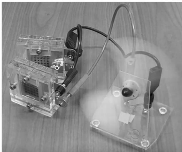
**Figure 2 : Circuit l'alimentation du ventilateur**
