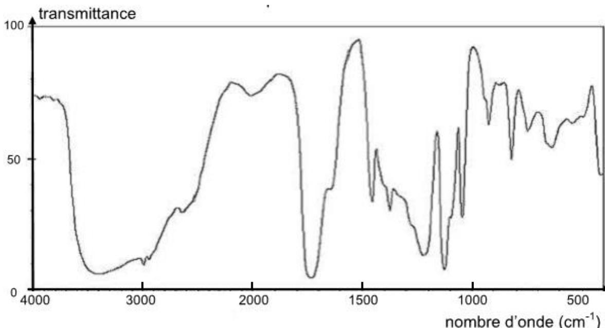
Figure 1. Spectre d'absorption IR de l'acide lactique
